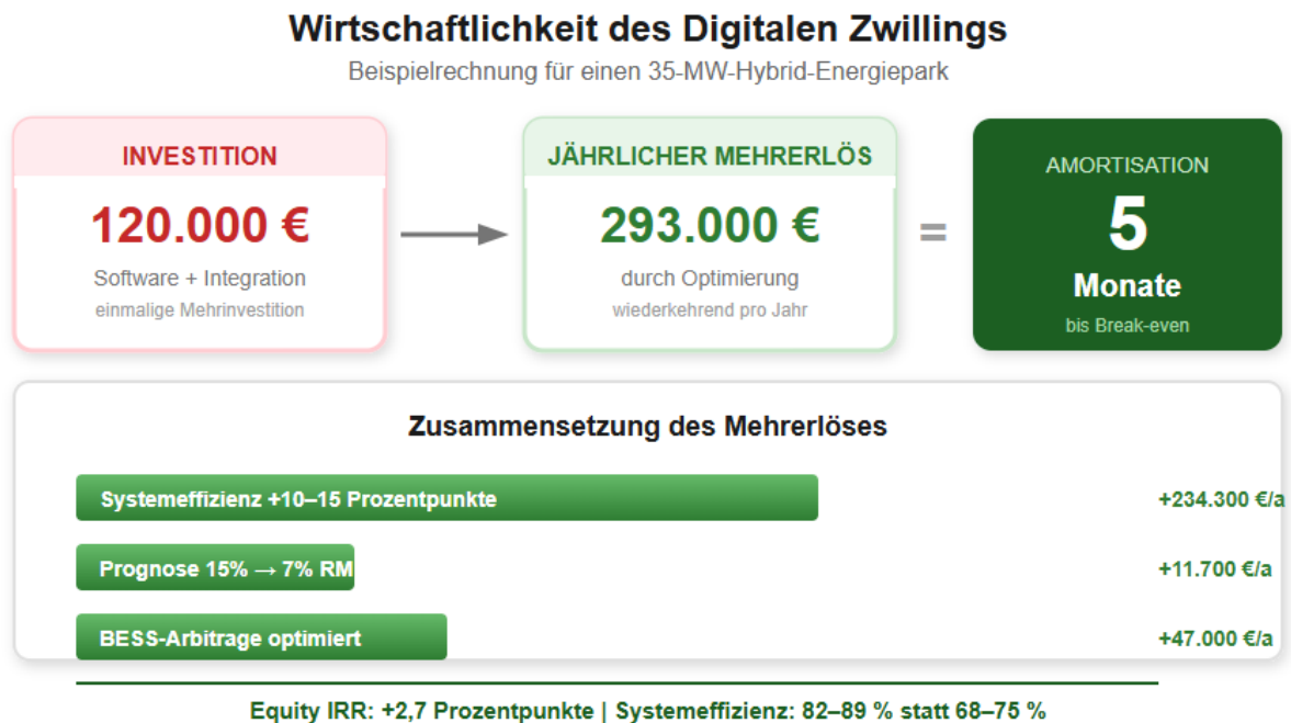
Abb. 5: Wirtschaftlichkeit des Digitalen Zwillings – Beispielrechnung für einen 35-MW-Hybrid-Energiepark. Investition 120.000 €, jährlicher Mehrerlös 293.000 €, Amortisation in fünf Monaten. Eigene Darstellung.
